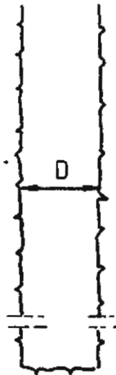
Abteufen der Bohrung ( Kernbohrung mit Luft- spülung )
