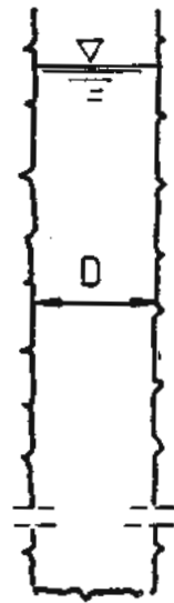
Bewässern des Bohrlochs
